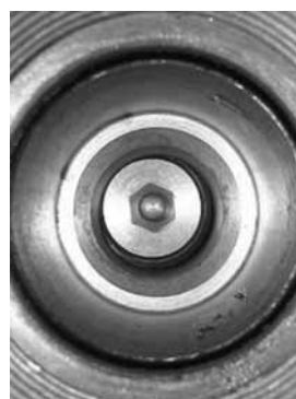
写真 2 同型式元弁の軸ズレの状態
