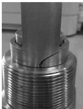
写真 1 同型式元弁の割れの状態
