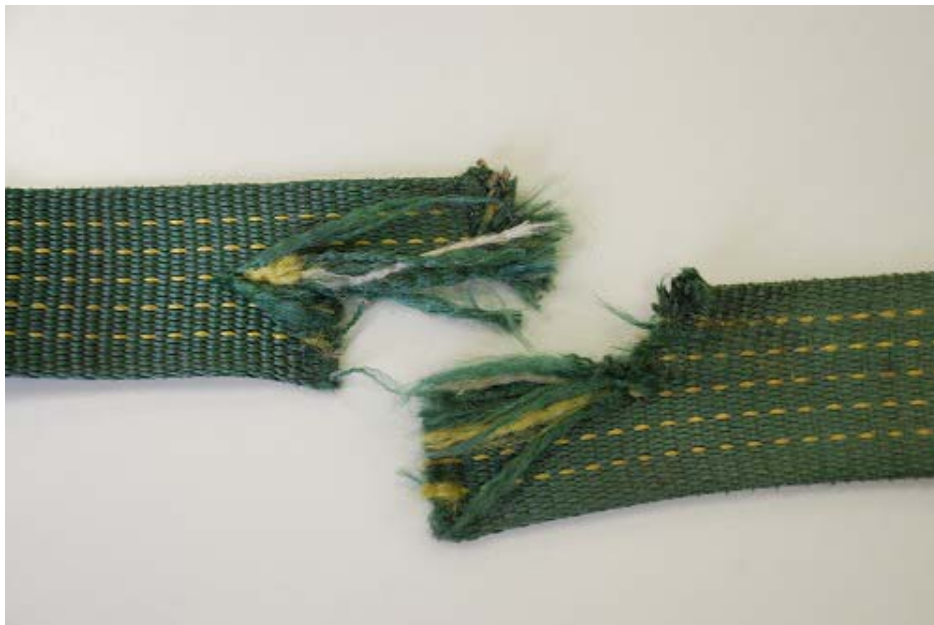
写真 切断した荷締め機のベルト
