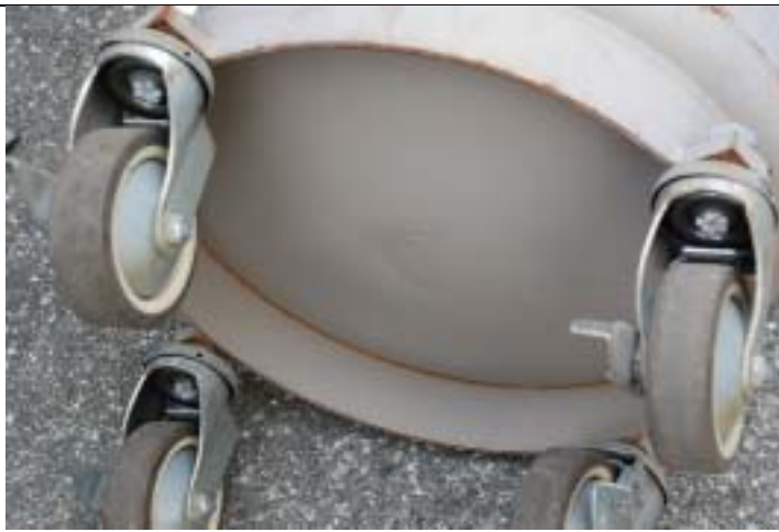
写真 下部鏡の損傷状況
