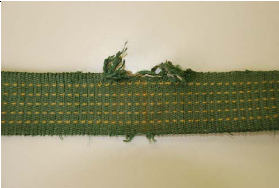
写真 ベルトの損傷
