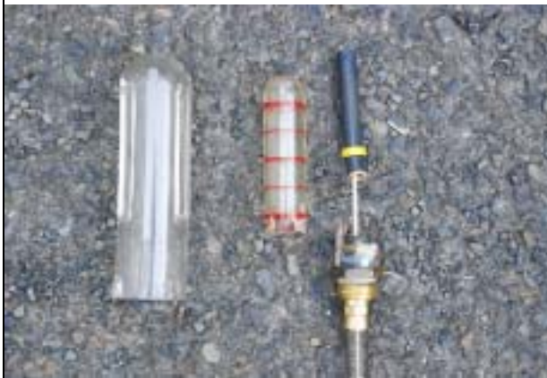
写真 液面計の損傷
